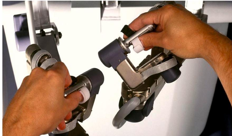
Fig. 4 - Manipoli, posizionati sotto il display, con i quali il chirurgo può controllare l'endoscopio e gli strumenti robotici.
