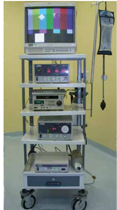
Fig. 16 - Colonna laparoscopica: 1) Monitor collegato a telecamera HD 2) Insufflatore di CO2 3) Irrigatore/aspiratore 4) Sorgente luce fredda
